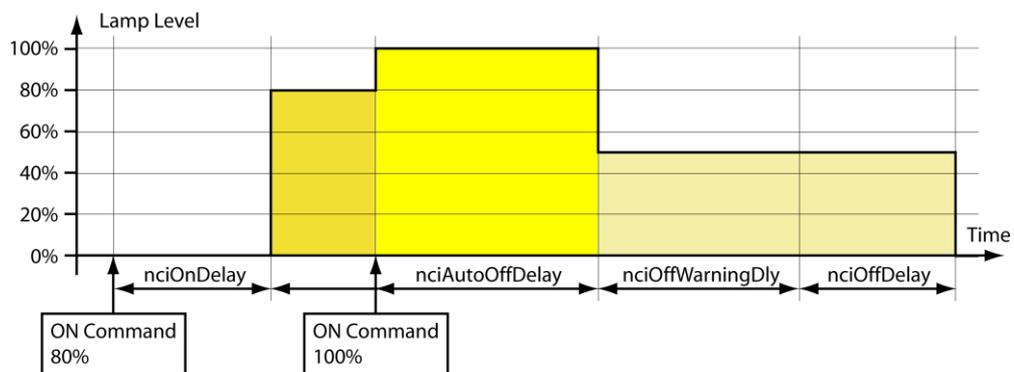
Figure 138: Timing Parameters (*nciAutoOffRestart=ST\_ON*)
